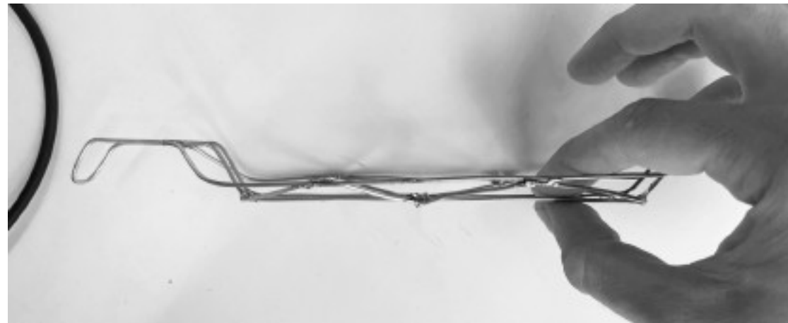
Formfindung und statische Optimierung mit Drahtmodellen
