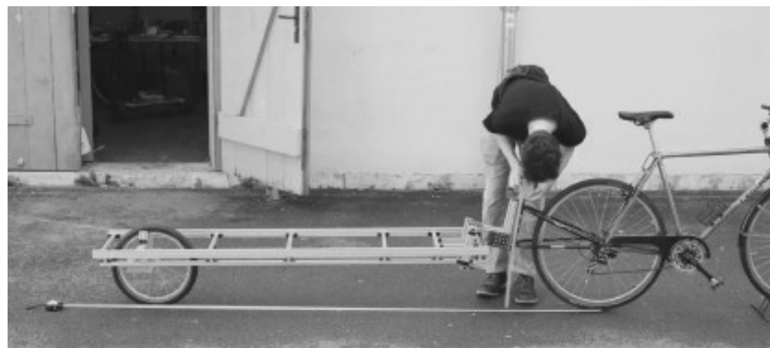
verstellbarer Anhänger-Prototyp für Realversuche und methodische Optimierung des Fahrverhaltens
